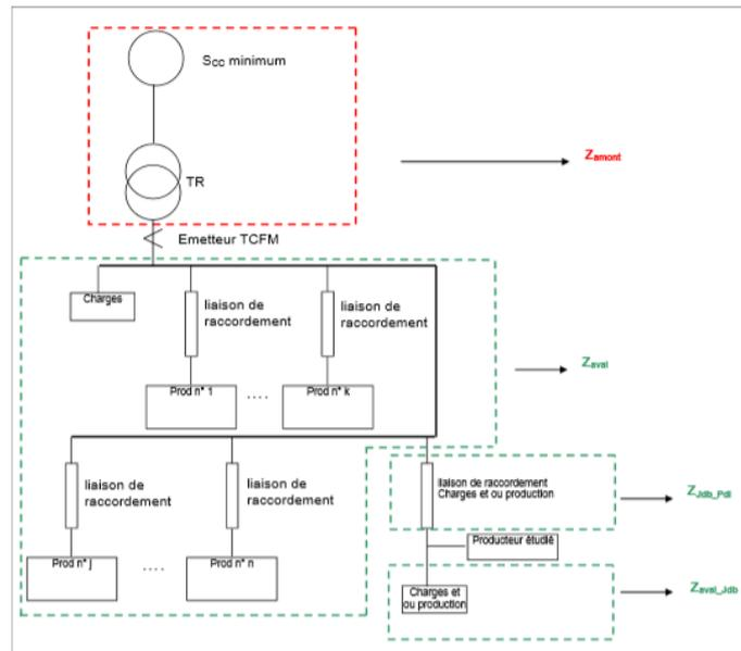
La première ( $Z_{jdb\_Pdl}$ ) correspond à l'impédance équivalente à 175 Hz de la liaison de raccordement avec les différentes charges et production sur l'artère HTA se situant entre le JDB et le producteur étudié. La seconde ( $Z_{aval\_Jdb}$ ) correspond aux charges et productions en aval du JDB.
