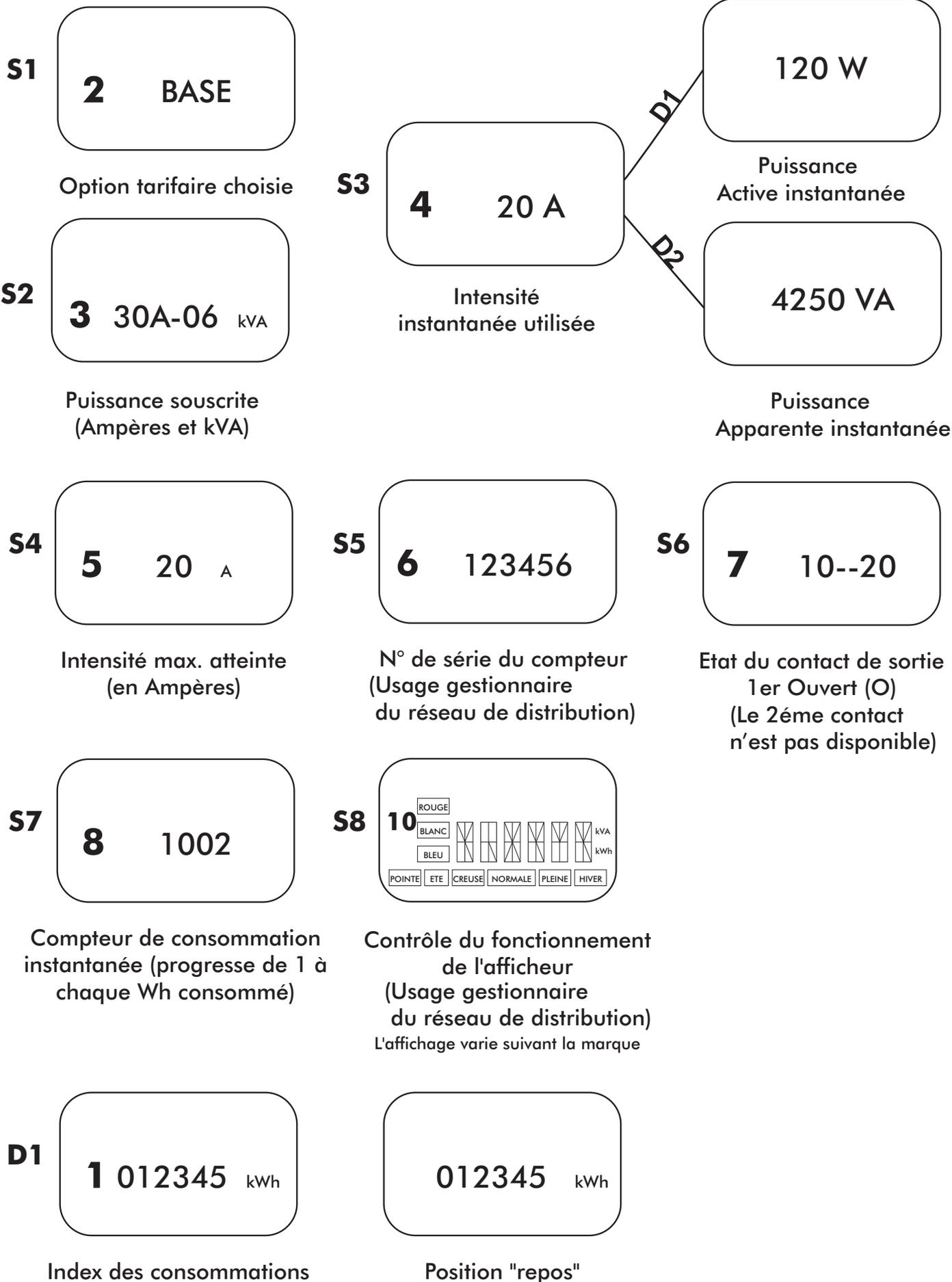
Les contacts de sortie sont inutilisés, le prix de votre kWh étant unique, aucun asservissement d'appareil ne peut être réalisé par le compteur.
