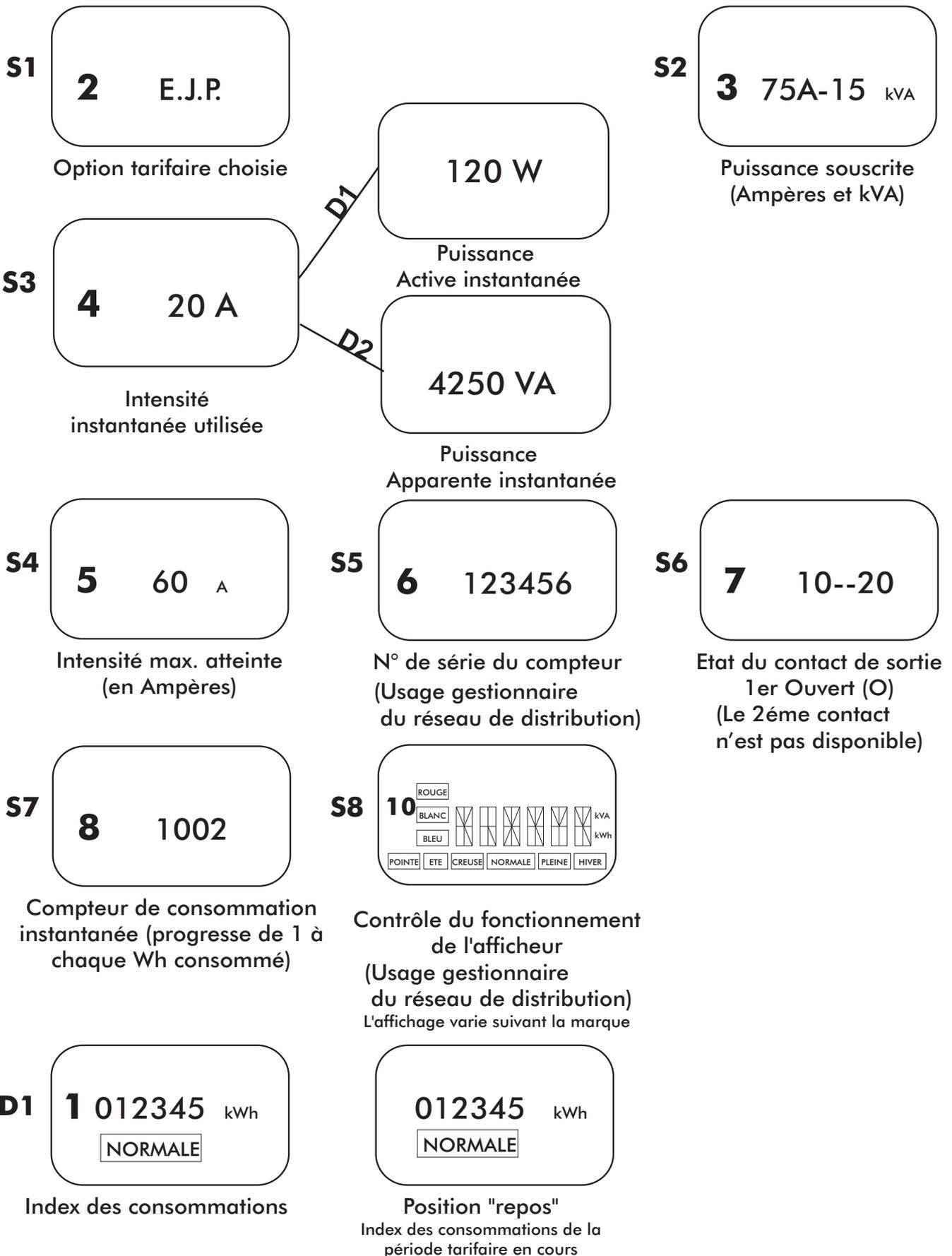
Vous avez intérêt à ne pas faire fonctionner certains appareils (chauffe-eau, radiateurs à accumulation . . .) en Heures de Pointe Mobile. Pour cela, il suffit de relier le relais-interrupteur, qui commande la mise sous tension ou hors tension de ces appareils, au contact d'asservissement de votre compteur.
